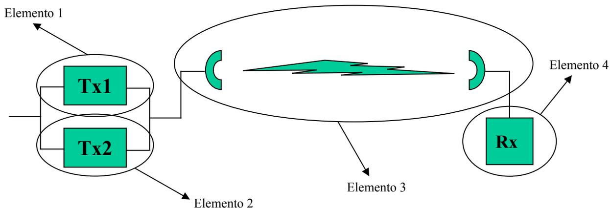
A continuación se muestra el diagrama funcional del sistema. Todos los elementos tienen una tasa media de falla = 0,05 fallas/año (MTTF=1 / 0,05 = 20 años), y tiempo medio de reparación MTTR = 20 horas
