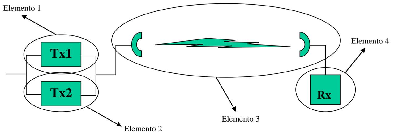
A continuación se muestra el diagrama funcional del sistema. Todos los elementos tienen una tasa media de falla = 0,05 fallas/año (MTTF=1 / 0,05 = 20 años), y tiempo medio de reparación MTTR = 20 horas
