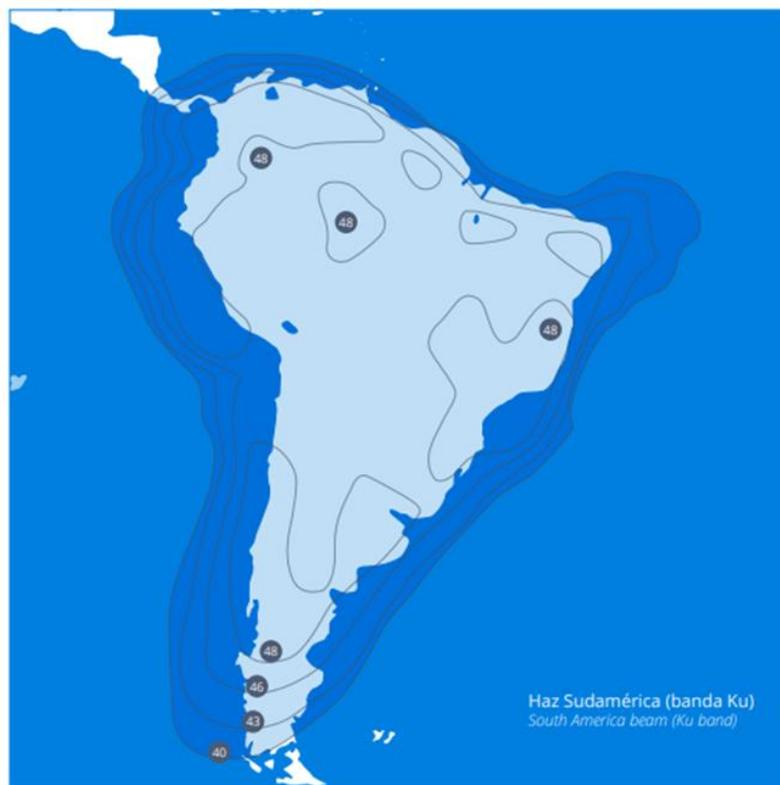
En los círculos se representa el PIRE (Potencia Isotrópica Radiada Equivalente) máximo sobre el cual se pinta la huella de cobertura. Como se aprecia, la huella es uniforme por cada territorio cubierto, es decir, para su distribución y transmisión solo es necesario el satélite, por lo que no intervienen otros elementos en este proceso.
